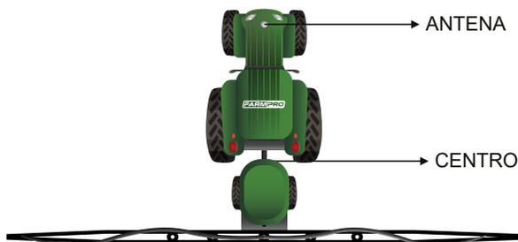
**Obs:** Instalar a antena X1 na ponta do trator e não no teto/cabine do trator.
