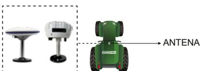
8.1. Se for X2/X3, posicione a Antena centralizada em cima da cabine.
