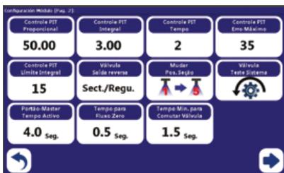
Caso tenha alguma válvula que o tempo de resposta na master é maior que 4seg ou na seção maior que 1,5seg, faça um teste de abertura e fechamento com a ajuda de um cronômetro e coloque o valor de demora para responder na abertura ou fechamento na opção Portão-Master Tempo Activo para a válvula Master e Tempo Min. Para Comutar Válvula para as Seções.
