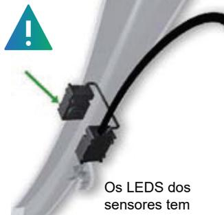
Os LEDs dos sensores tem que ficar alinhados.
